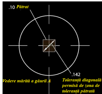
Figura 7.74.Orificiu mărit cu zonă de toleranță exagerată
